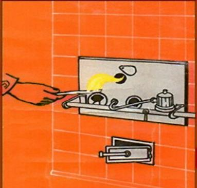
Перед растопкой печей, оборудованных под газовое отопление, проветрите топливник, затем убедитесь, есть ли тяга в дымоходе.
