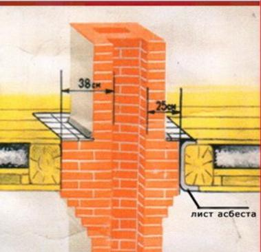
В местах соприкосновения печи или дымовой трубы со сгораемыми конструкциями дома должны быть устроены кирпичные разделки толщиной не менее 38 см; при условии защиты деревянных конструкций асбестом или войлоком, смоченным в глиняном растворе. - 25 см.
